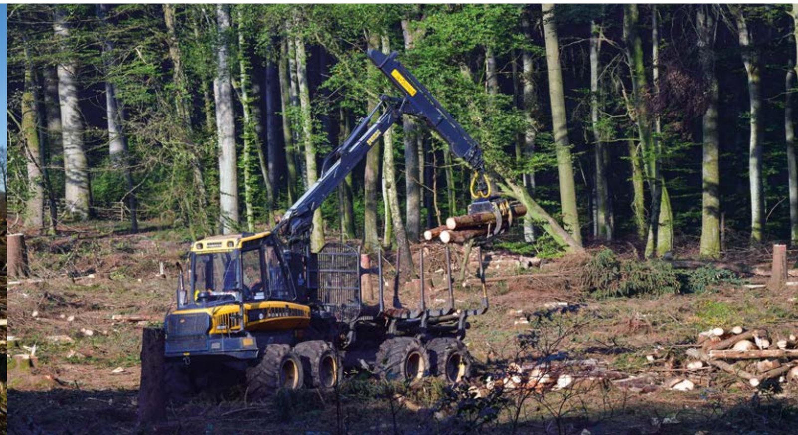
Durch die Befahrung mit schweren Holzerntemaschinen werden Wasserspeicher- und Pufferungsvermögen der Böden beeinträchtigt oder zerstört
